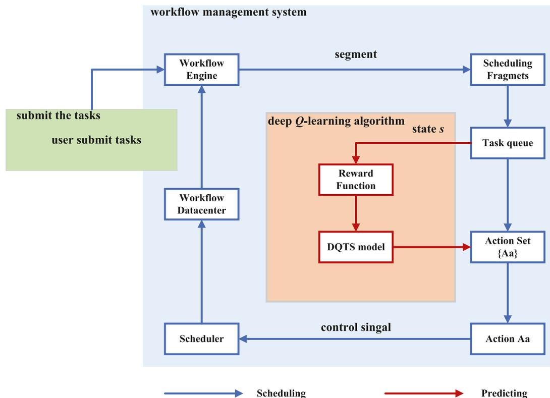
Fig. 4. Architecture of DQTS in WorkflowSim.
